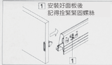
面板側面調節: 向右1mm
